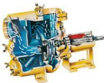
При вращении рабочего колеса смесь воздуха и жидкости из всасывающей системы закачивается в насос (см. рис.). Затем в рабочей блоке насоса воздух отделяется от воды и через отверстие в верхней части корпуса выходит наружу.
